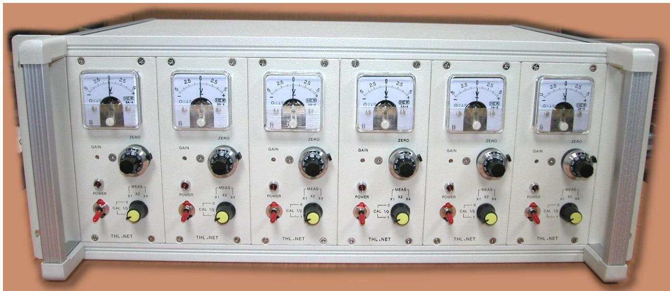
波高計 6 CHANNEL 電源箱
